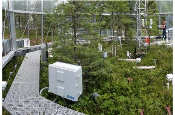
Figur 2B Innhegning der \text{CO}_2 -konsentrasjonen er doblet og temperaturen er økt med 9^\circ\text{C} .
